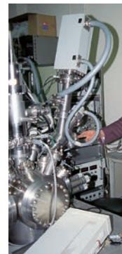
■電子・イオンデュアル収束ビームを用いた微小領域三次元分析のための試作装置。直径数マイクロメートル以下の微粒子や材料の微小な領域を、収束イオンビームを用いて三次元加工を行いながら収束電子ビームを用いて高感度分析を行う。これにより、固体内部の三次元元素分布を0.1マイクロメートル以下の分解能で明らかにすることができます。
