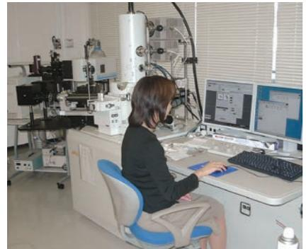
■電子線励起による発光、回折、電流等を測定する複合分析装置
