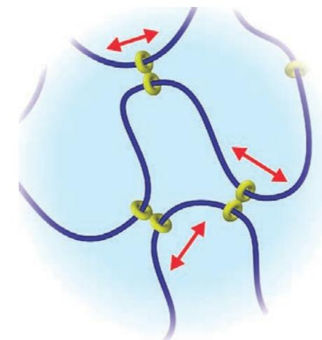
■架橋点が自由に動く環動高分子材料の模式図。
