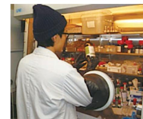
■グローブボックス等を活用した不活性ガス雰囲気下での実験を駆使して、空気・水に対し不安定な化合物さえも自在に合成します。
