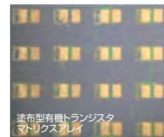
■ プレークスルーのカギを握る塗布型有機半導体結晶 Solution-processed printed organic single crystals
