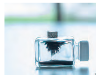
■ 熱流と電流をそれぞれ直交する方向に変換できる「熱電永久磁石」 "Thermoelectric permanent magnet" enabling conversion of heat and charge currents in orthogonal direction
